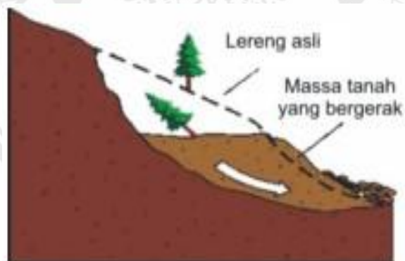
Gambar 2.3. longsoran tipe nendatan ( Slumping )
