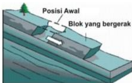
Gambar 2.4. Longsoran tipe luncuran ( Sliding )
