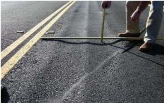
Gambar 2.3 alur pada lintasan roda
